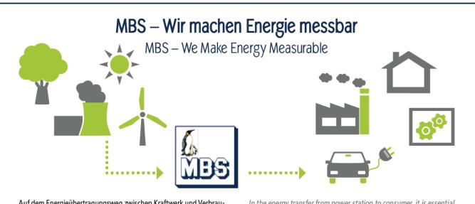
Auf dem Energieübertragungsweg zwischen Kraftwerk und Verbraucher ist an einer Vielzahl von Messstellen die korrekte Erfassung der Stromstärken notwendig. Dies erfolgt mit Hilfe von Stromwandlern. MBS produziert ein umfangreiches Sortiment an Niederspannungs-Stromwandlern für Mess- und Schutzzwecke.
