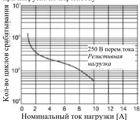
Срок службы электрических элементов при нагрузке по перем.току
