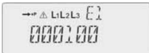
Рисунок 4 - Отображение на ЖКИ кода ошибки “E1 000100”
